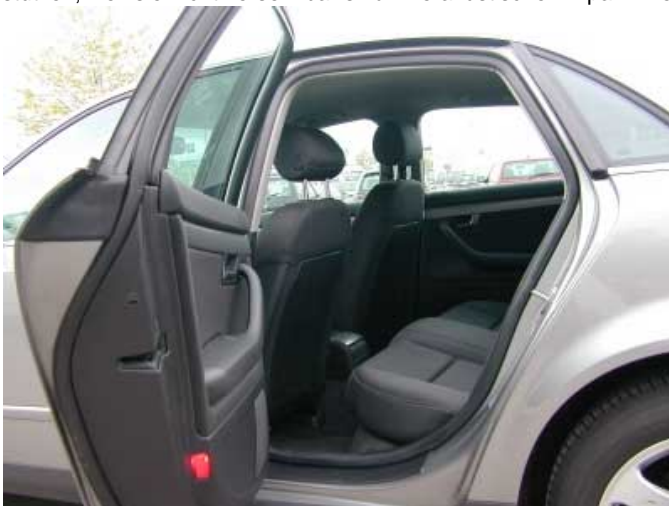
Der schmale Durchstieg macht das Erreichen der Rücksitzbank beschwerlich.
