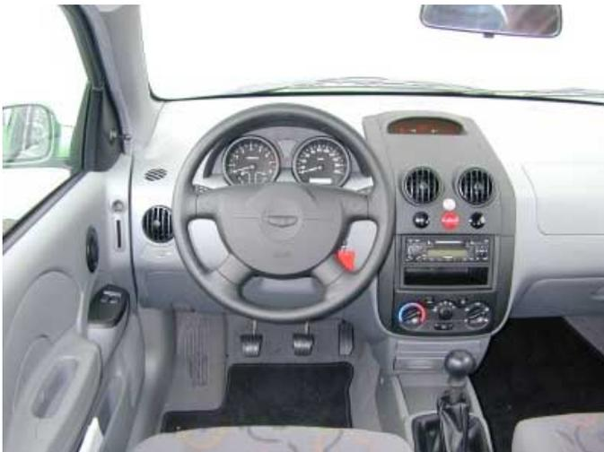
Licht und Schatten auch bei der Fahrzeugbedienung. Während die Instrumente gut ablesbar und übersichtlich sind, fallen die Bedienelemente für Heizung und Lüftung durch ihre zu tiefe Position negativ auf.
