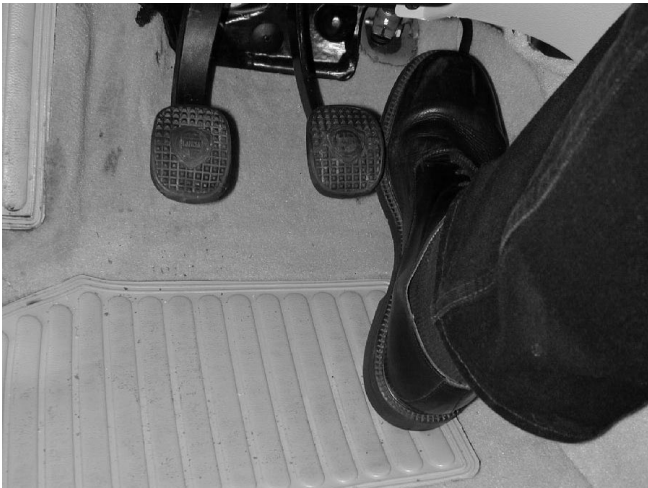
Die Pedalabstände sind so gering, dass man beim Wechseln der Pedale leicht hängen bleibt.
