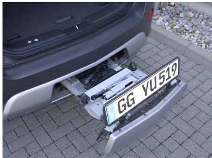
Leicht und unkompliziert lässt sich der integrierte Fahrradträger herausnehmen und bietet Platz für zwei Fahrräder.
