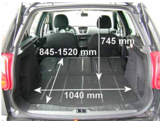
Mit 325 l Volumen ist der Kofferraum des 207 SW in dieser Fahrzeugklasse recht groß.
