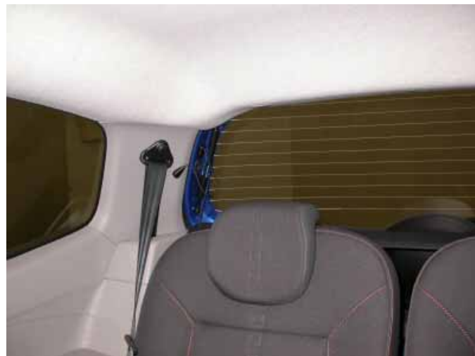
Die versenkbaren Kopfstützen verbessern die Sicht nach hinten.
