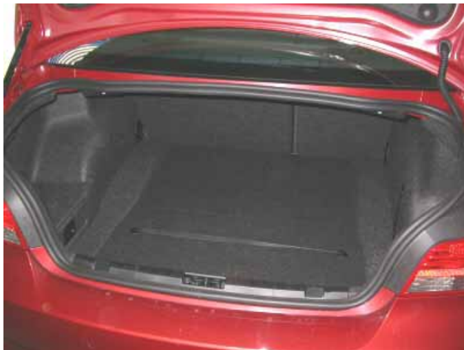
Mit 325 l Volumen ist der Kofferraum um 35 l größer als beim Pendant mit Schrägheck.
