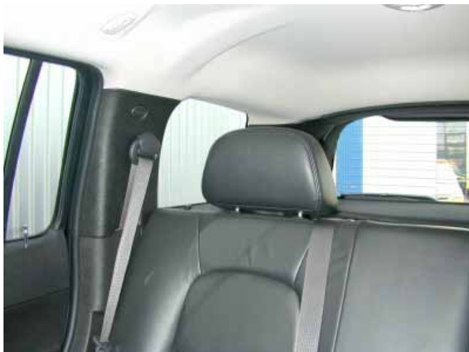
Die Übersichtlichkeit ist aufgrund der kleinen Fensterflächen und breiten Dachsäulen eingeschränkt.
