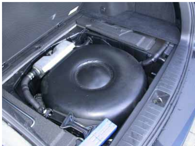
Der Flüssiggastank ist platzsparend in der Ersatzradmulde untergebracht.
