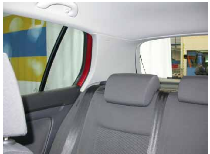
Besonders nach schräg hinten ist die Sicht aufgrund der sehr breiten Dachsäulen erheblich eingeschränkt.
