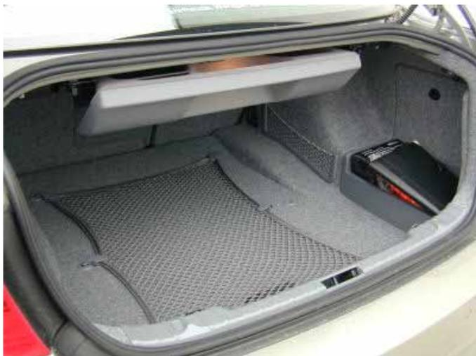
Mit 405 l Volumen ist der Kofferraum von klassenüblicher Größe. Gegen Aufpreis gibt es ein Gepäckraumpaket mit praktischen Gepäckraumnetzen und einer ausziehbaren Schublade unter der Hutablage.
