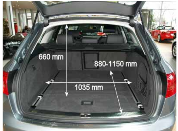
Mit 415 l Volumen ist das Gepäckabteil um fast 100 l kleiner als bei der A6-Limousine.
