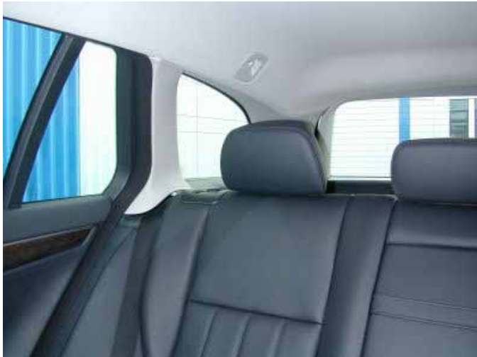
Die Sicht nach schräg hinten wird durch die nicht versenk- oder klappbaren Kopfstützen beeinträchtigt.
