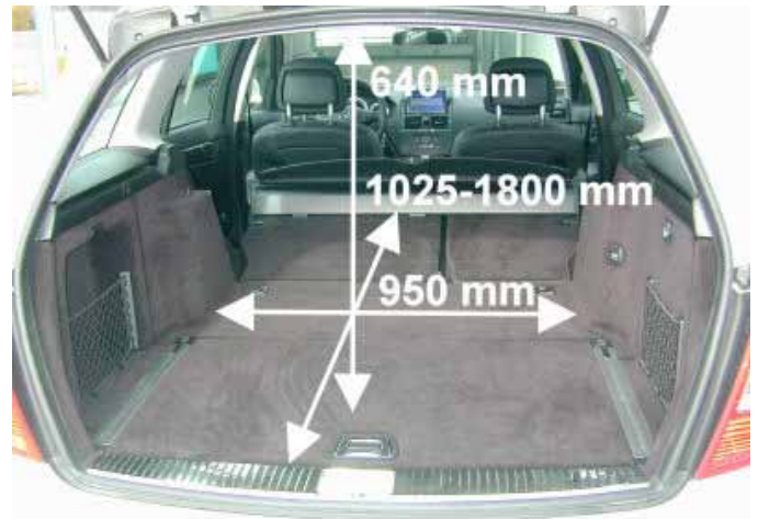
Der Kofferraum des neuen T-Modells ist um 10 l gewachsen und liegt mit 355 l Volumen weiterhin im klassenüblichen Durchschnitt.
