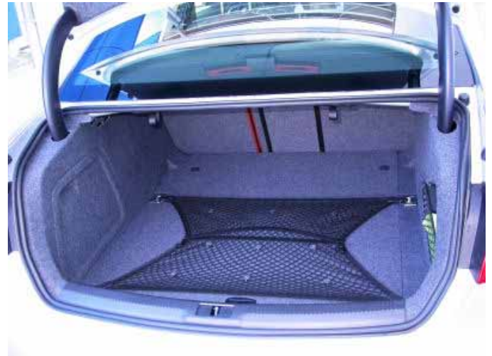
Mit 380 l Volumen ist der Kofferraum des A4 um 45 l kleiner als beim Vorgänger.
