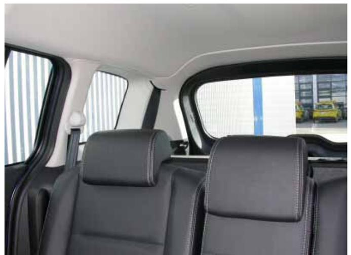
Wie bei vielen aktuellen Fahrzeugen ist die Sicht nach schräg hinten aufgrund der breiten Dachsäulen stark eingeschränkt.
