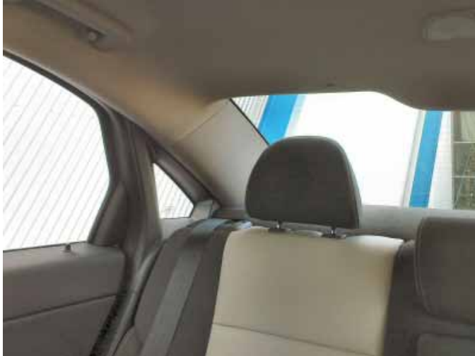
Breite Dachsäulen sowie nicht klapp- oder versenkbare Kopfstützen schränken die Sicht nach hinten doch erheblich ein.
