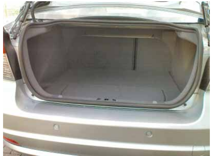
Der Kofferraum ist mit 400 l Volumen von klassenüblicher Größe. Störend ist die wegen der weit nach hinten ragenden Heckscheibe sehr klein geratene Ladeöffnung.
