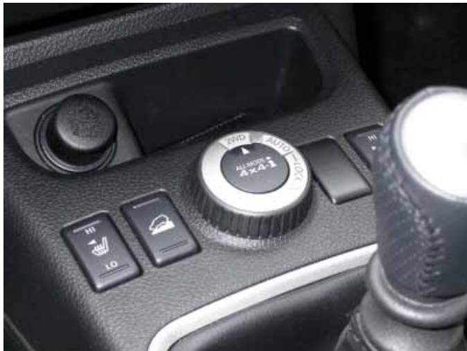
Der Bergabfahr- bzw. Berganfahrassistent und der Drehschalter zum Wählen der Antriebsart bieten dem Fahrer die Möglichkeit, den X-Trail auf die jeweiligen Fahrbahnbedingungen einzustellen.
