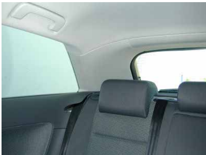
Die sehr breiten Dachsäulen schränken die Sicht nach schräg hinten erheblich ein.
