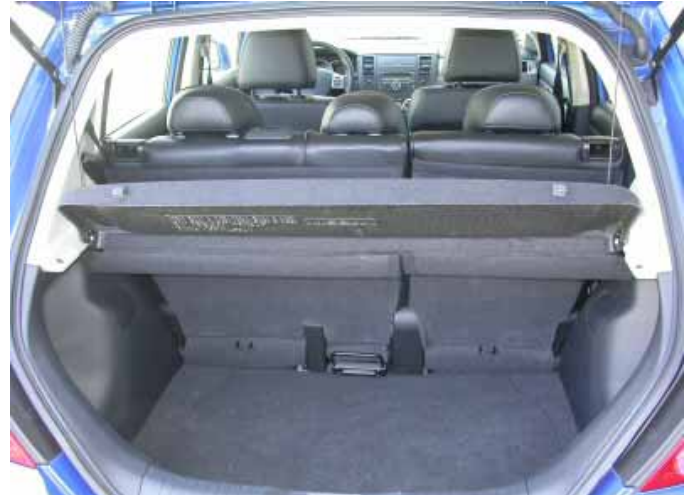
Mit 305 l Kofferraum kann der Tiida zwar an die Marktführer VW Golf, Opel Astra oder Ford Focus nicht heranreichen, das Volumen lässt sich aber durch Vorrücken der Sitzbank beträchtlich erhöhen.
