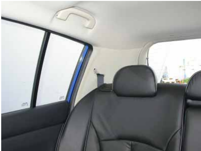
Die Sicht nach schräg hinten wird durch die extrem breite C-Säule sehr stark eingeschränkt.
