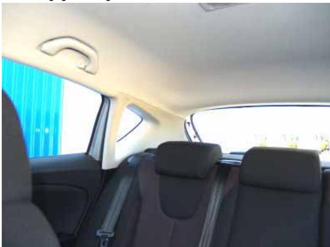
Breite C-Säulen bzw. Dachpfosten beeinträchtigen die Sicht nach schräg hinten.
