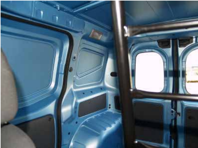
Die Sicht nach hinten wird durch fehlende seitliche Fenster und durch die breiten Stege der Hecktüren stark beeinträchtigt.
