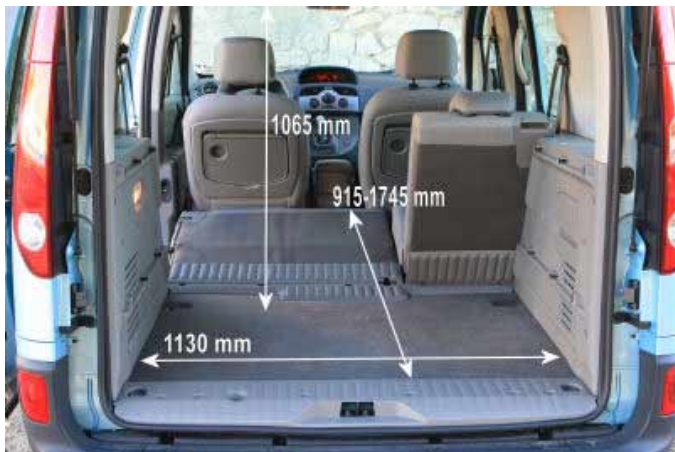
Der Kofferraum des neuen Renault Kangoo mit 430 l Volumen ist zwar gegenüber dem Vorgänger (495 l) kleiner geworden, in dieser Fahrzeugklasse aber immer noch recht üppig.
