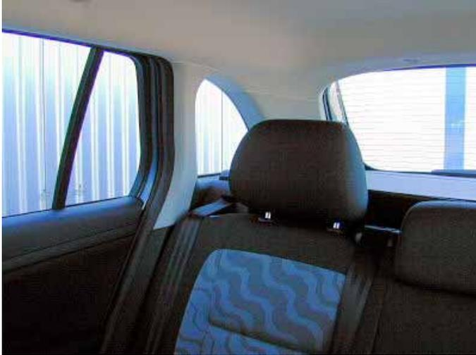
Die Sicht nach hinten wird durch die nicht versenkbaren Kopfstützen stark eingeschränkt.
