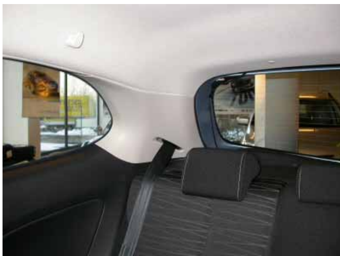
Der Blick nach schräg hinten wird durch die besonders breite C-Säule stark beeinträchtigt.
