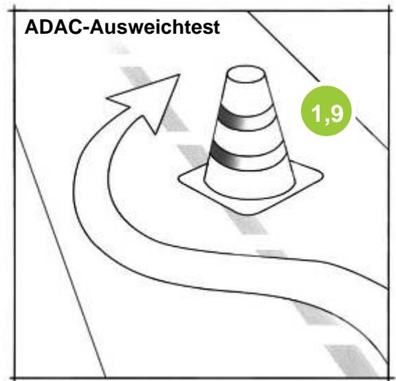
Beim ADAC-Ausweichtest erfolgt die Einfahrt in die Pylonengasse mit einer Geschwindigkeit von 90 km/h bei mindestens 2000 Motorumdrehungen im entsprechenden Gang. Geprüft wird die Fahrzeugreaktion, d.h. die Beherrschbarkeit beim anschließenden Ausweichen.
