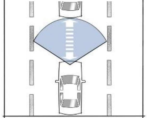
Mit Radarsensoren erkennt das System vorausfahrende Autos und reguliert bei aktivem Tempomat durch Gasgeben und -wegnehmen den Abstand zum Vordermann. Neuere Systeme regeln bis Stillstand (etwa im Stop-and-go-Verkehr) und warnen akustisch, optisch sowie mit leichtem Bremseneingriff vor Kollisionen.
