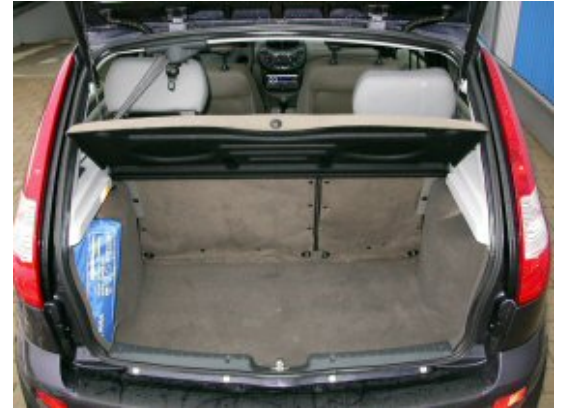
Mit 240 l Volumen besitzt der Kalina einen Kofferraum von klassenüblicher Größe.
