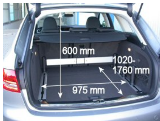
Mit 375 l Volumen ist der Kofferraum des A4 Avant annähernd so groß wie bei der Limousine (380 l).
