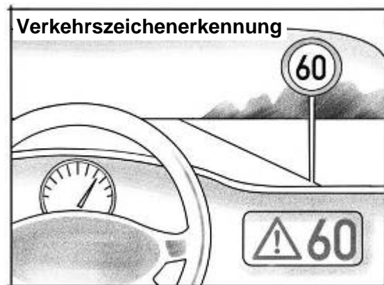
Eine Videokamera an der Fahrzeugfront erkennt Verkehrszeichen, die auf Tempolimits oder Überholverbote hinweisen und stellt diese in einer Anzeige im Armaturenbrett dar.
