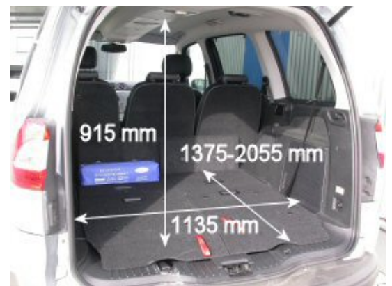
Der Galaxy bietet mit 570 l Volumen einen ansprechend großen Kofferraum. Einem Ford S-Max mit 625 l oder einem Eurovan (z.B. Citroen C8) mit 780 l Volumen muss er sich jedoch geschlagen geben.
