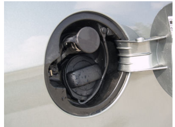
Der kombinierte Befüllanschluss für Erdgas und Benzin befindet sich unter der Serientankklappe.
