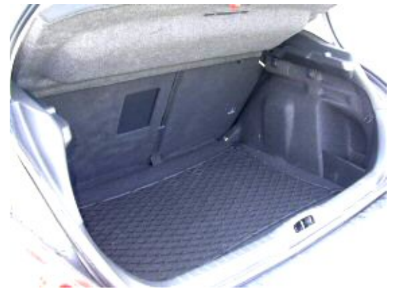
Mit 340 l Volumen ist der Kofferraum des 308 geringfügig kleiner als beim Vorgänger 307 (345 l).
