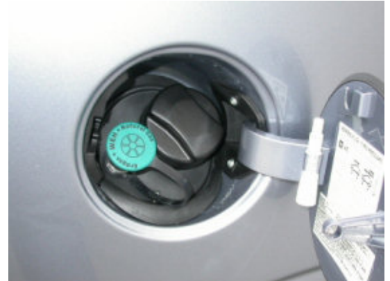
Der Einfüllstutzen für den Gastank ist unter der Tankklappe positioniert.
