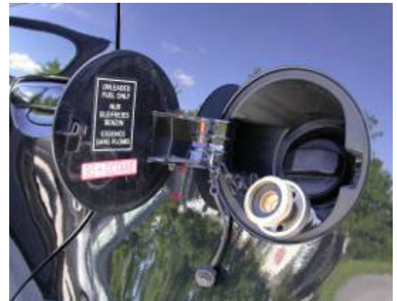
Der kombinierte Befüllanschluss für Autogas und Benzin befindet sich unter der Serientankklappe.
