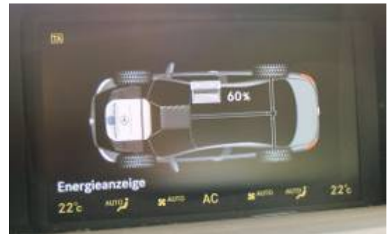
Sowohl im Geschwindigkeitsdisplay als auch im Borddisplay kann jederzeit der Betriebszustand des Hybridsystems abgerufen werden.
