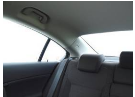
Die sehr breiten C-Säulen schränken die Sicht nach schräg hinten erheblich ein.
