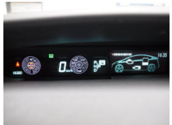
Auf dem Borddisplay kann man unter anderem den Betriebszustand des Hybridsystems jederzeit kontrollieren.
