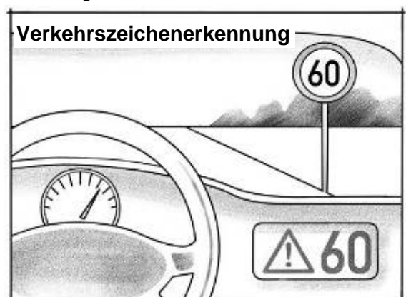
Verkehrszeichenerkennung Eine Videokamera an der Fahrzeugfront erkennt Verkehrszeichen, die auf Tempo-Limits oder Überholverbote hinweisen und stellt diese für einige Sekunden in einer Anzeige im Armaturenbrett dar.
