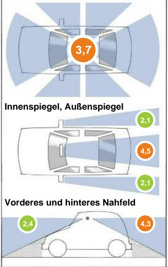
Die Rundumsicht-Note informiert über die Sichtbehinderung des Fahrers durch Fensterpfosten und Kopfstützen. Bei den Innen- und Außenspiegeln werden deren Sichtfelder aus dem Blickwinkel des Fahrers bewertet. Die Noten des vorderen und hinteren Nahfeldes zeigen, wie gut der Fahrer Hindernisse unmittelbar vor bzw. hinter dem Fahrzeug erkennt.
