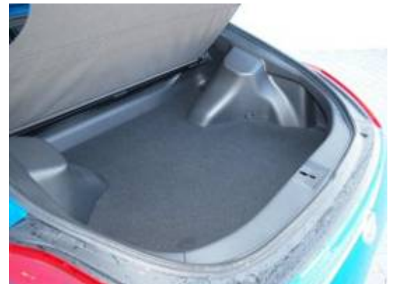
Der sehr flache Kofferraum stellt lediglich 185 l Volumen für das Gepäck zur Verfügung.
