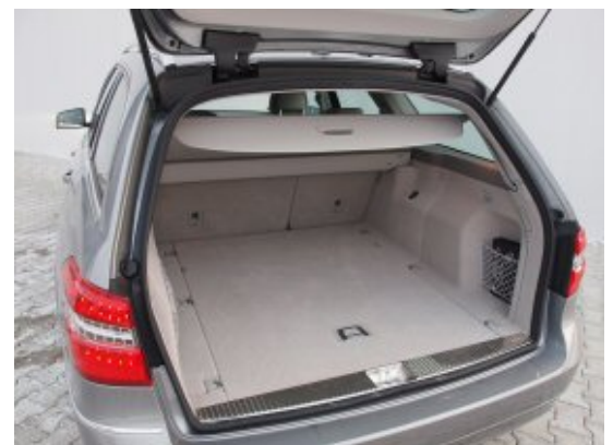
Mit 515 l Volumen bietet das T-Modell erheblich mehr Platz für das Gepäck als die Stufenhecklimousine (455 l).
