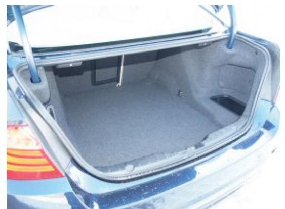
Mit 425 l Kofferraumvolumen bietet der aktuelle 5er um 30 l weniger Platz für das Gepäck als der Vorgänger.
