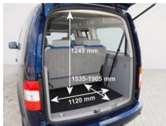
Der Kofferraum des VW Caddy Maxi ist in dieser Fahrzeugklasse riesig: Stolze 970 l Volumen stehen bei fünf Sitzplätzen zur Verfügung. Mit sieben Sitzplätzen bleiben immer noch 346 l Volumen fürs Gepäck.
