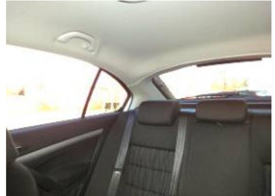
Versenkbare Kopfstützen erleichtern die Sicht nach hinten.
