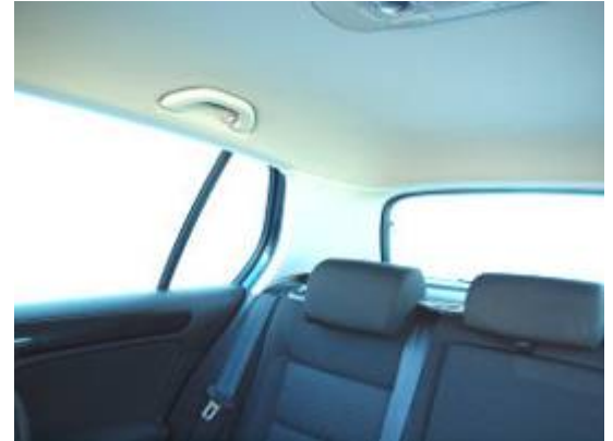
Die besonders breite C-Säule schränkt die Sicht nach schräg hinten stark ein.
