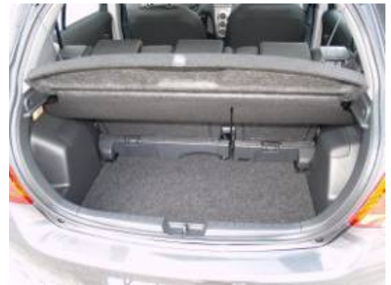
Der Kofferraum des Toyota Yaris zählt mit 225 l Volumen zu den Kleinsten in dieser Fahrzeugklasse.
