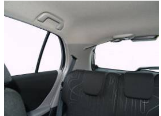
Sowohl die versenkbaren Kopfstützen als auch die nicht zu breiten Dachsäulen erleichtern die Sicht nach schräg hinten.
