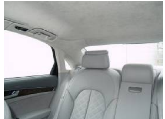
Breite Dachsäulen und nicht versenkbare Kopfstützen erschweren die Sicht nach schräg hinten erheblich.
