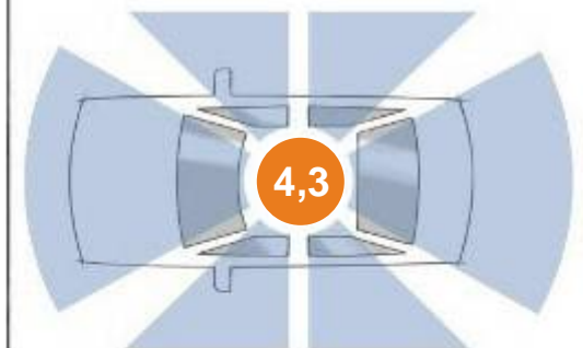
Breite Dachsäulen und nicht versenkbare Kopfstützen erschweren die Sicht nach schräg hinten erheblich.
