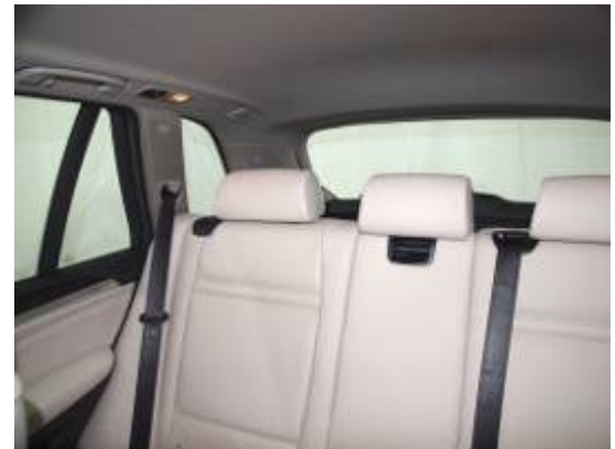
Breite Dachsäulen und nicht versenkbare Kopfstützen erschweren die Sicht nach hinten.
