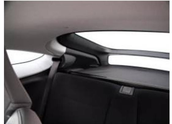
Die schrägen Dachsäulen und die zweigeteilte Heckscheibe erschweren die Sicht nach hinten sehr.
