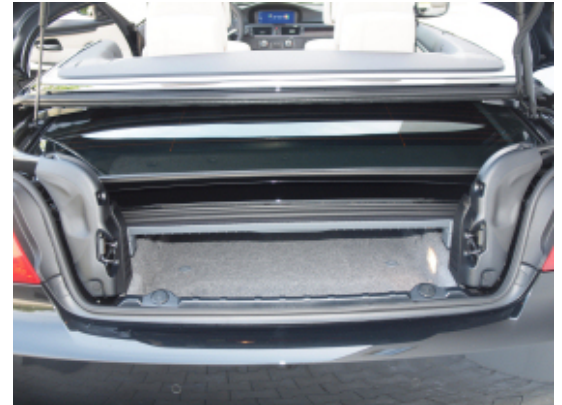
Bei geschlossenem Verdeck steht ein Kofferraumvolumen von 255 l zur Verfügung. Ist es jedoch geöffnet, verringert sich das Volumen erheblich.
