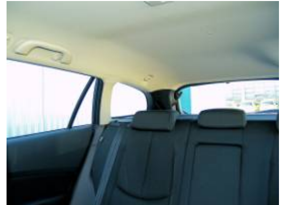
Schmale Dachsäulen und versenkbare Kopfstützen erleichtern die Sicht nach hinten.
